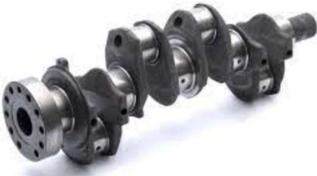
Figura 9.1. Arbore cotit pentru un motor cu patru cilindri dispuși în linie.
